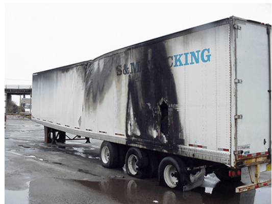
Dommages causés par le feu à une semi-remorque sans tracteur
