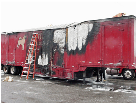
Dommages causés par le feu à une remorque de déménagement et d'entreposage
