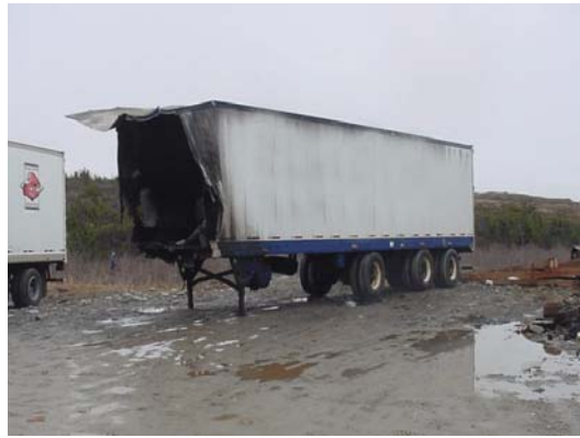
Dommages causés par le feu à une remorque
