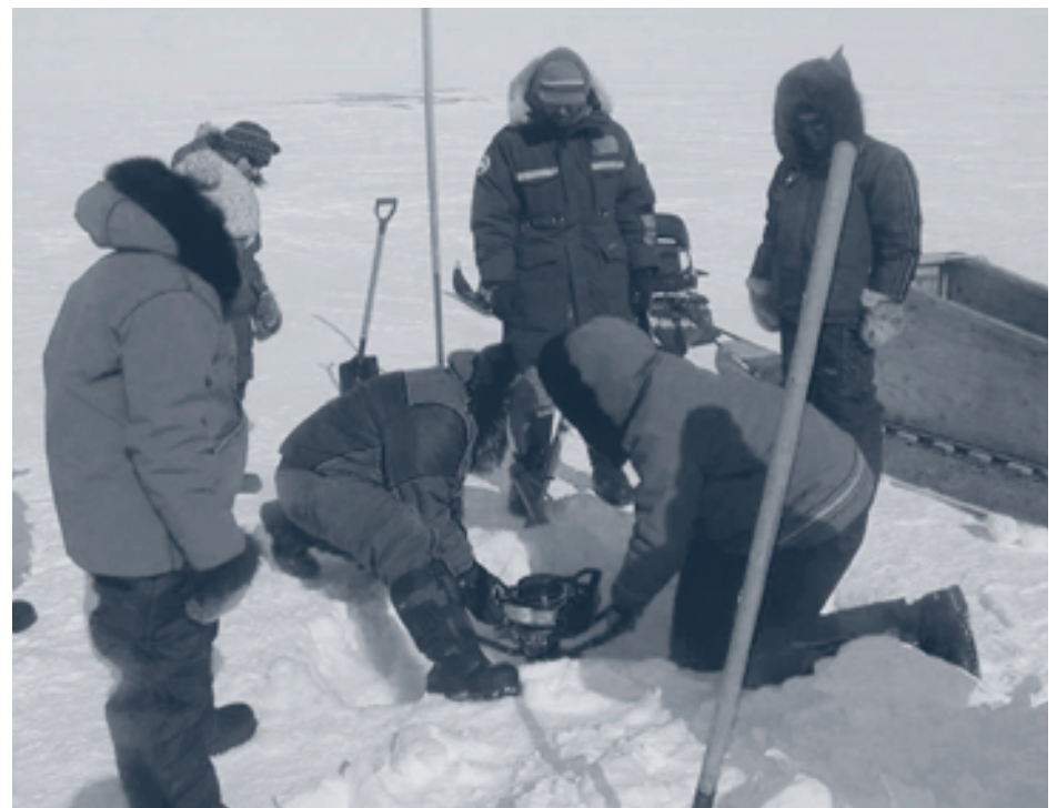
Figure 6 Des étudiants du Collège de l'Arctique du Nunavut utilisent un vilebrequin à glace afin de pratiquer une ouverture pour la collecte de zooplancton et les lectures physiques in situ , dans le cadre d'un cours du programme de technologie environnementale donné sur le terrain en hiver. Photo: T. Dick.
