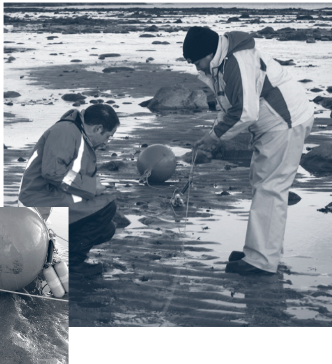
Figure 4 Des étudiants du Collège de l'Arctique du Nunavut préparent l'enregistreur de données pour surveiller la température et la pression (profondeur) au cours d'un cycle de marées. A) Illustration agrandie d'un enregistreur de données. Photo: T. Dick.
