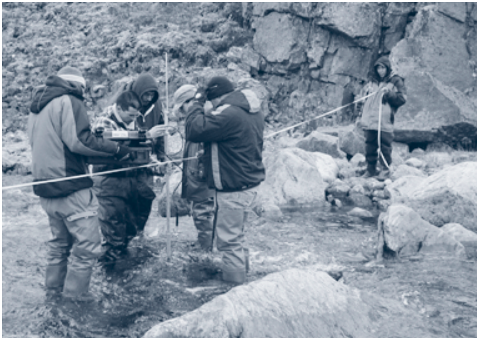
Figure 5 Des étudiants du Collège de l'Arctique du Nunavut utilisent un débitmètre acoustique portable pour mesurer le courant d'un bout à l'autre du lit d'un cours d'eau, pour qu'on puisse calculer son débit total. Photo: T. Dick.
