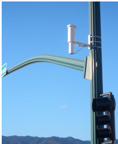
**Un dispositif de Mobile Detect installé sur un lampadaire**, dans le cadre d'un projet pilote parrainé par la ville de Colorado Springs, afin de détecter dans les véhicules qui circulent à proximité de l'équipement radiologique qui pourrait être utilisé dans les armes ou autre matériel radiologique de contrebande.
