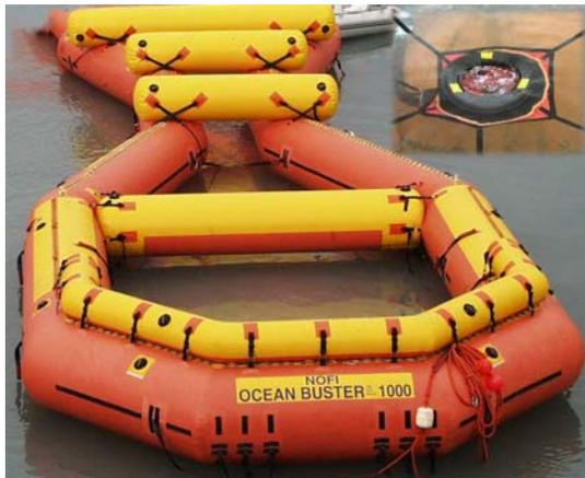
Figure 9 : OB avec l'entrant (inset) du récupérateur intégré
