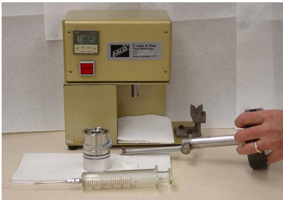
**Figure 3 : Banc d'essai BOTD de Falex**
