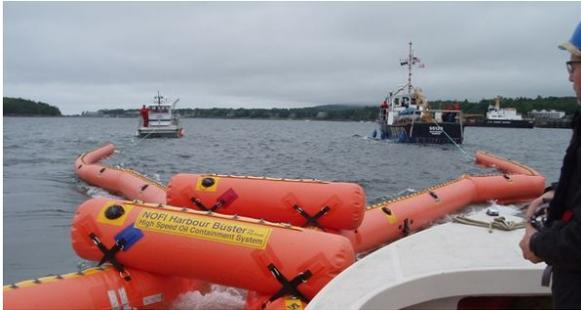
Figure 1 : OTTERboom montrant une courbure réduite
