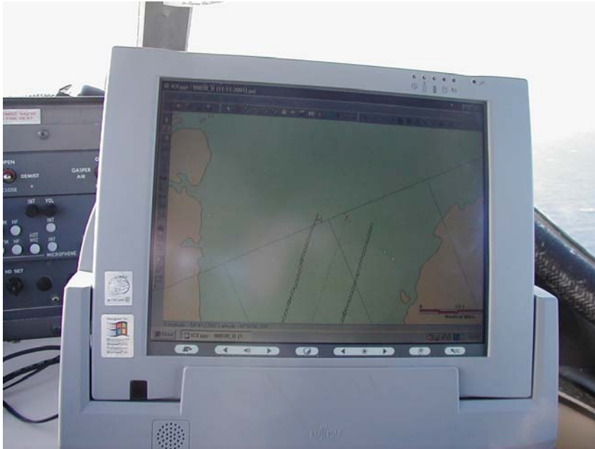
Vue de l'interface Pen computer lors d'un vol expérimental de reconnaissance des glaces à bord de l'avion Canice-3 - Environnement Canada
