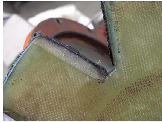
Figure 8 : Plaques sur roulettes après 3 heures
