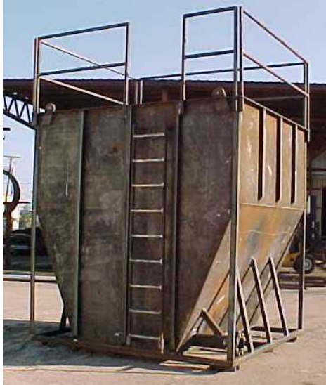
Figure 13 : montre le bac d'essai de 125 barils prêt à être recouvert
