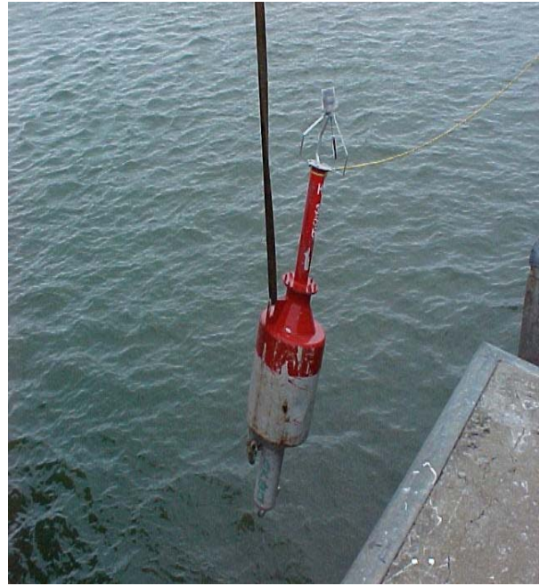
Figure 19 : Bouée testé avec un stabilisateur
