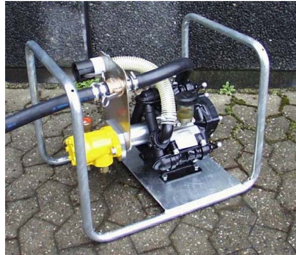
Figure 14 : présente l'une des pompes de graissage à injection à l'eau requises pour le projet.
