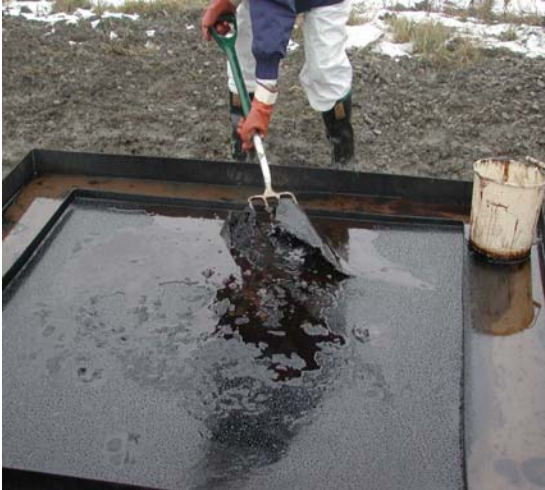
Figure 11 : Résidu ayant la texture de l'asphalte
