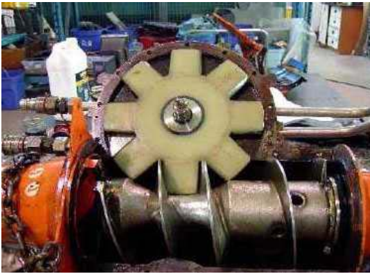
Figure 7 : Pompe GT 185 et plaque sur roulettes
