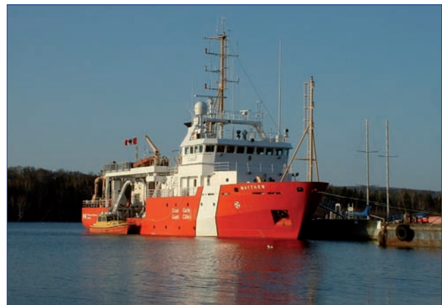
Le Matthew est équipé d'un sonar multifaisceaux. Ce navire de la Garde côtière canadienne transporte également à son bord deux vedettes utilisées pour la cartographie multifaisceaux, dont celle qui mouille à ses côtés.
