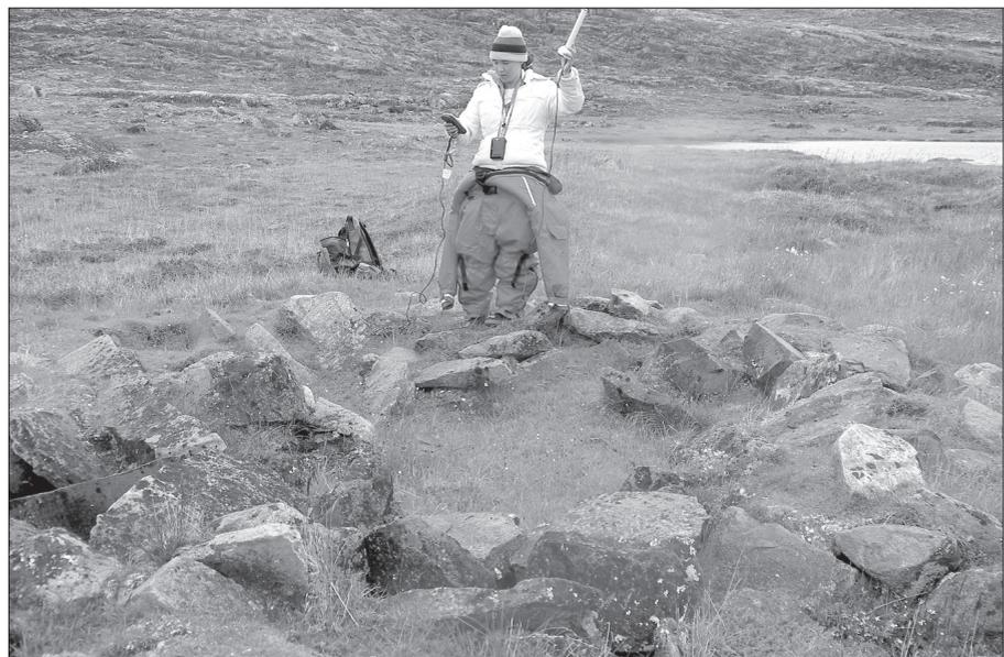
Kaviq Kaluraq, du lac Baker, utilise un DGPS (GPS différentiel) pour relever la position d'une habitation d'hiver Thulé à la pointe Tinnittuqtuq.
