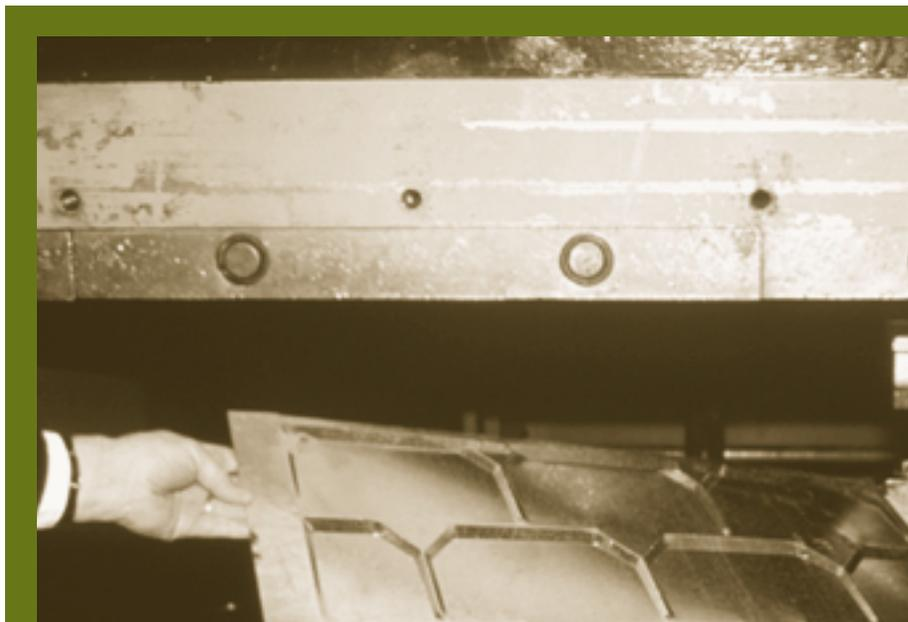
Un bardeau de métal moulé subsistant a servi de prototype pour fabriquer des bardeaux de remplacement dans le cadre du projet de restauration de la résidence principale de Homestead-Motherwell, près d'Abernethy, en Saskatchewan. Pour la *restauration*, les réparations ou les remplacements de pièces détériorées ou manquantes sont, en règle générale, faits à l'identique d'après les éléments physiques existants, des preuves documentaires et des témoignages oraux.
