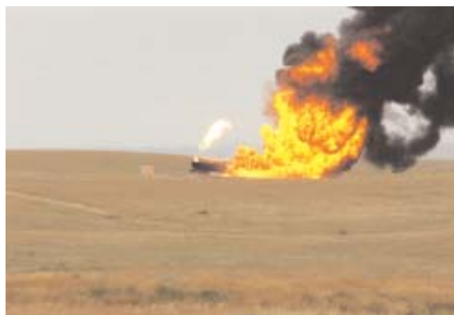
Figure 2. Première combustion du propane liquide de la partie inférieure de la citerne
