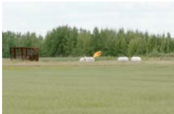
Figure 6 – Taille de la flamme alimentée par la vapeur à pression presque ambiante
