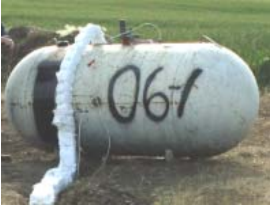
Figure 1 – Instrumentation installée sur le réservoir de propane
