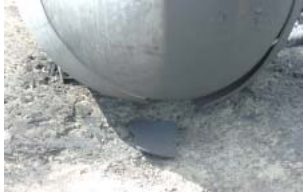
Figure 8 – Rupture fragile de la citerne de l'Essai 06-2
