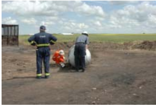
Figure 2 – Site d'essai – Préparation pour la combustion du propane
