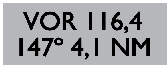
POINT DE VÉRIFICATION DE RADIAL VOR ET DU DME
