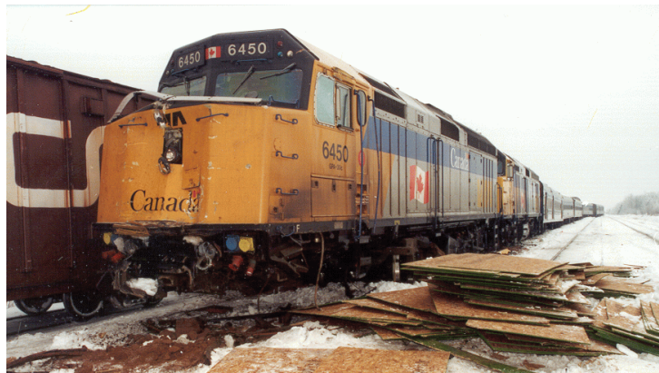
Photo 2. Une partie des dommages subis par la locomotive de tête VIA 6450. Notez le bogie avant déplacé sous le centre de la locomotive (ce qui a endommagé les coffres à batteries et le réservoir de carburant diesel) et les marques laissés par l'impact sur les montants anticollision à l'avant de la locomotive.
