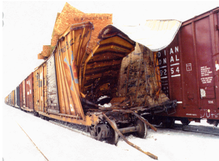
Photo 1. Dommages causés au premier wagon de marchandises (CNA 553997, chargé de panneaux de fibre) qui a été heurté par le VIA 14 sur la voie NC-22
