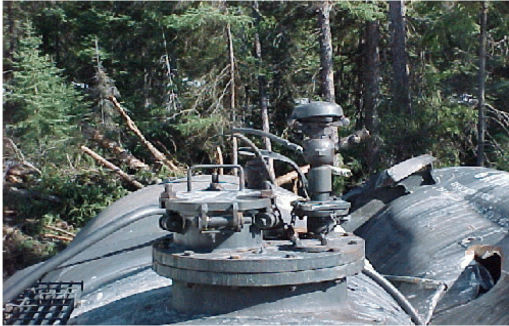
Figure 3 - Ensemble typique de raccords supérieurs sur un wagon-citerne de spécification 111
