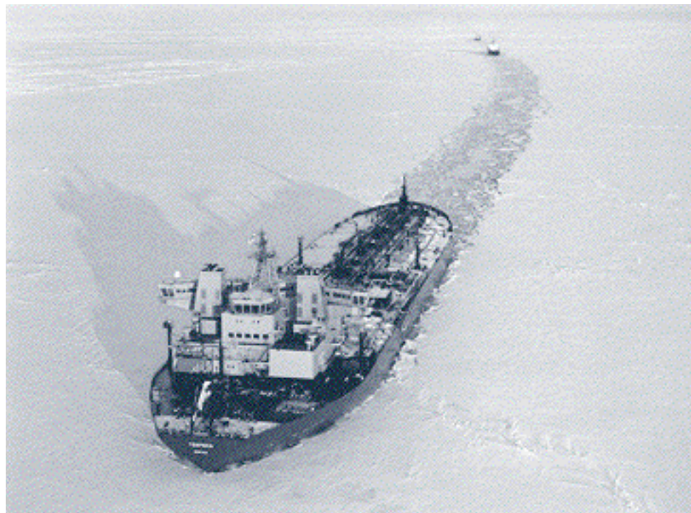
Figure 4 Le pétrolier brise-glace à double effet M/V Tempera en action dans la glace.
