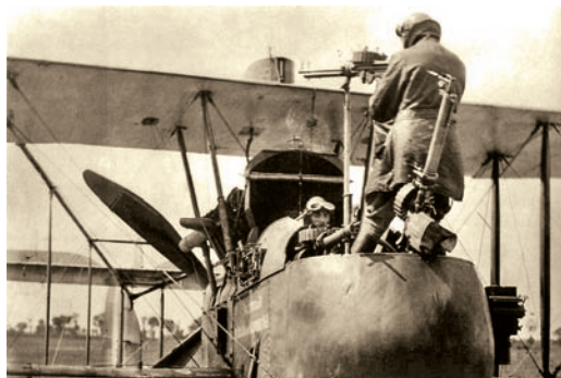
Un observateur de FE2d fait une démonstration de maniement de la mitrailleuse arrière. Le poste de l'observateur était équipé de trois mitrailleuses dont une mitrailleuse avant fixe permettant son utilisation par le pilote, une mitrailleuse avant manœuvrable et une mitrailleuse arrière montée sur un poteau au-dessus de l'aile supérieure. L'observateur devait se tenir debout sur son siège pour utiliser la mitrailleuse arrière.
