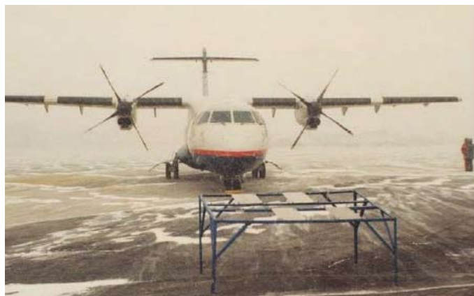
Pendant l'essai initial de durée d'efficacité, les durées obtenues sur plaque horizontale ont été comparées aux durées d'efficacité réelles sur aile, et l'on a déterminé que l'utilisation de la méthode à plaque horizontale était représentative des surfaces d'un aéronef. Photo : APS Aviation
