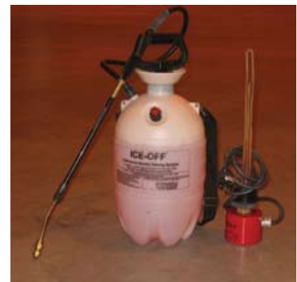
Figure 1: Le Ice-Off est un exemple de distributeur de liquide d'antigivrage de Type 1. Il nécessite une alimentation de 120 V c.a. pour chauffer le liquide.
