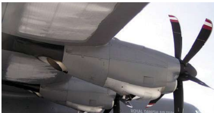
Givre sur l'intrados d'une aile imprégnée de froid
