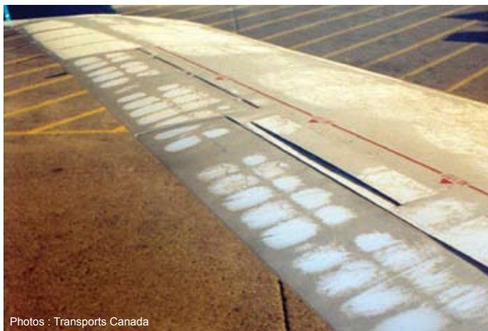
Plaques de givre sur une aile.
