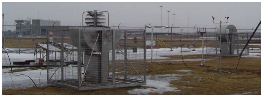
Figure 2 : Système D-Ice expérimental, qui mesure fréquemment l'équivalence en eau liquide des précipitations et d'autres paramètres. Les résultats sont communiqués directement au centre de dégivrage, aux équipes de dégivrage, au bureau de la régulation des vols et à l'équipage de conduite dans le poste de pilotage.
