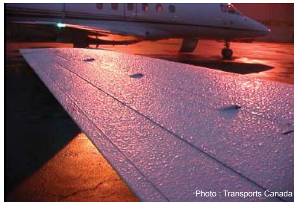
Glace sur les ailes causée par de la pluie verglaçante.
