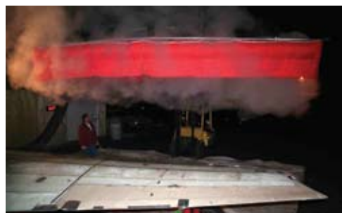
Figure 1 : Vapeur tempérée : Une première version de la buse de pulvérisation de vapeur tempérée avant qu'elle soit abaissée sur l'aile givrée. Photo: APS Aviation
