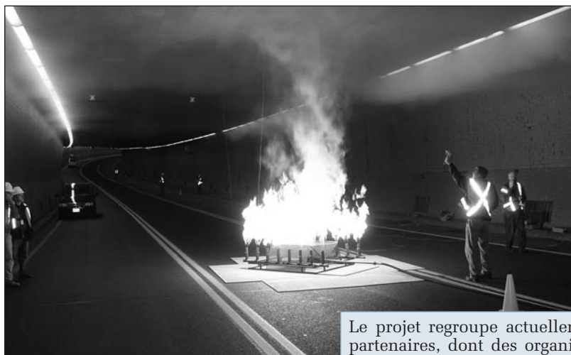
Essai incendie grandeur réelle effectué par les chercheurs de l'IRC-CNRC dans un tunnel routier de Montréal
