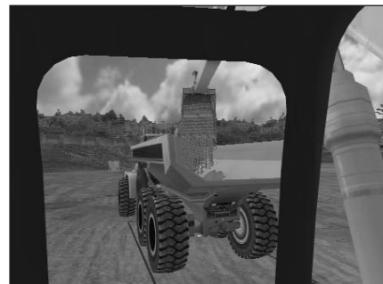
Simulateur personnel pour la formation des opérateurs de machinerie lourde qui reproduit une « pelle hydraulique virtuelle » de façon réaliste
