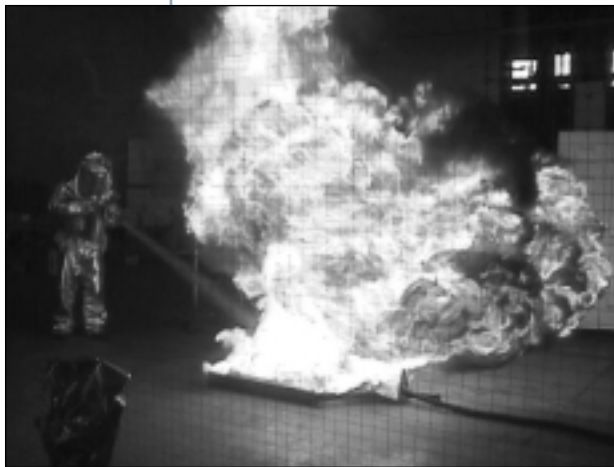
L'opérateur éteint un incendie au moyen d'un extincteur portatif aux halocarbures.
