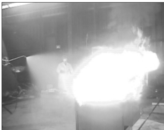
Un extincteur par brouillard d'eau est mis à l'essai dans une cuisine commerciale simulée.
