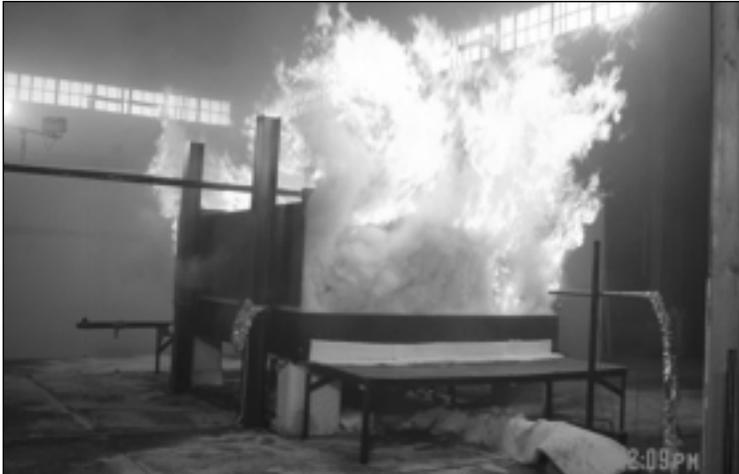
Essai d'extinction par brouillard d'eau dans un grand bassin de cuisson industriel
