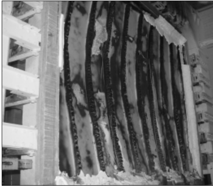
Les poteaux de bois de ce mur ont subi un flambage (déformation latérale) durant l'essai d'incendie.
