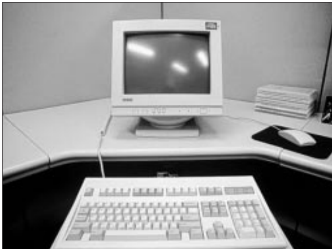
Figure 1. Les luminaires derrière l'employé assis produisent des reflets gênants sur l'écran de l'ordinateur.
