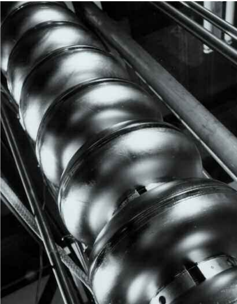
Structures d'accélérateur supraconductrices constituées de niobium et mises au point dans le cadre des travaux de recherche en vue de la construction d'un collisionneur linéaire.
