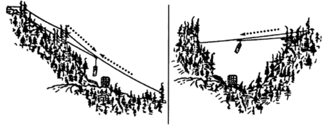
Figure 2.2 – Pont roulant sur câble aérien
