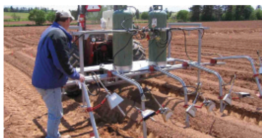
David Main vérifie un lance flamme. Un lance flamme tiré par un tracteur constitue une méthode novatrice de lutte contre les mauvaises herbes actuellement mise à l'essai dans le domaine de l'agriculture biologique.
