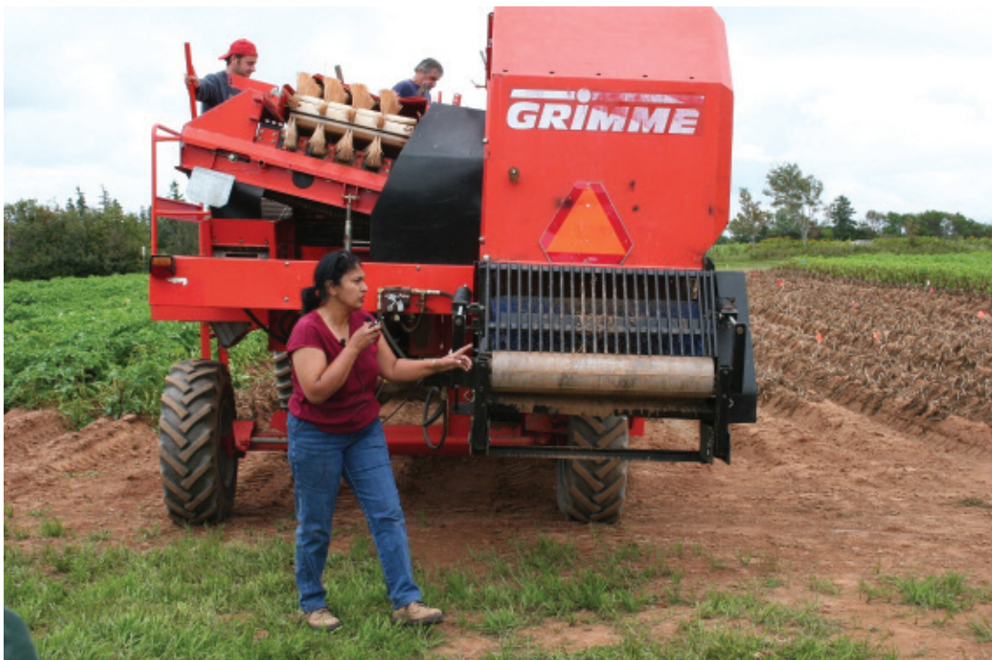
Christine Noronha fait la démonstration d'un broyeur permettant de lutter contre le charançon du maïs.
