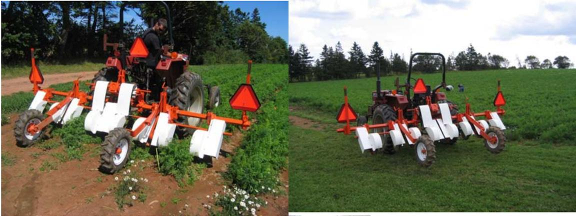
Faucheuse à 4 rangs sur plates-bandes ensemencées sur 4 rangs espacés de 86 cm d'un centre à l'autre
