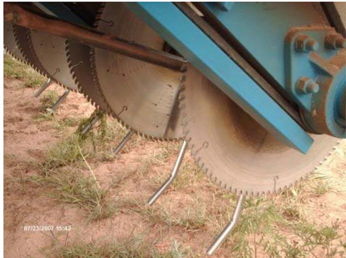
Une faucheuse à 9 rangs sur des plates-bandes ensemencées à 9 rangs espacés de 46 cm d'un centre à l'autre. La quantité de couvert enlevée est moins évidente dans la prochaine diapositive. Il s'agit ici d'une version « PTO » utilisant des lames de scie ronde.
