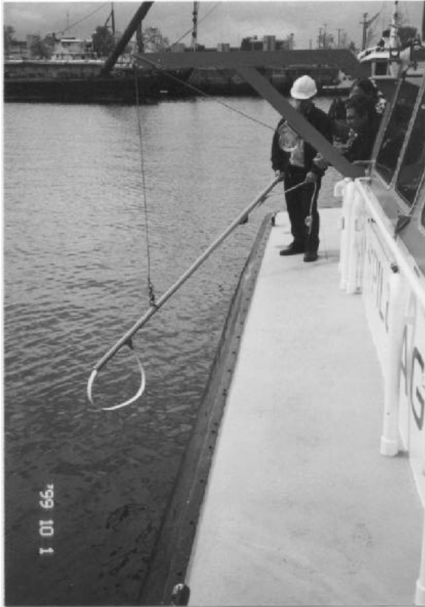
Perche Mate Saver servant à la récupération d'un homme à la mer inconscient, à bord d'un des deux nouveaux bateaux-pilotes à Québec. Les bateaux-pilotes sont également munis de dispositifs de récupération du type engin de sauvetage Jason.
