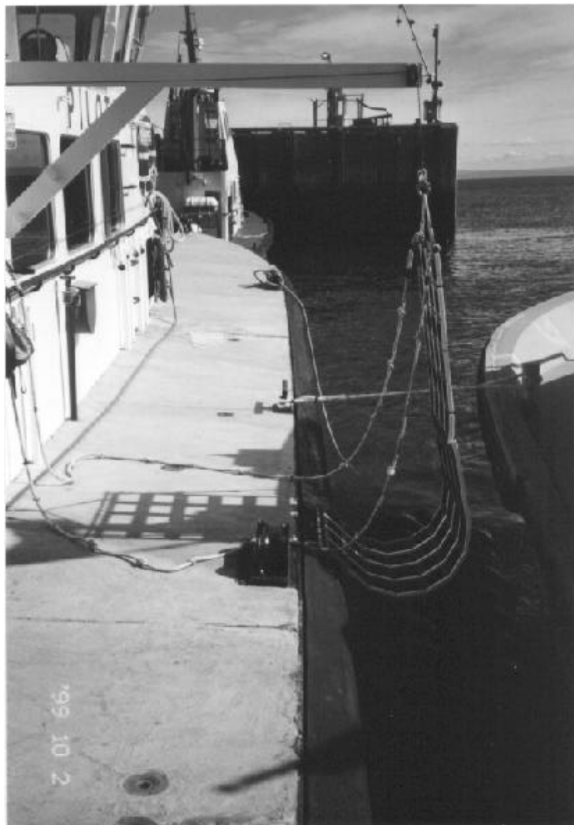
Installation temporaire du dispositif de récupération (engin de sauvetage Jason) à bord du « CHARLEVOIX »
