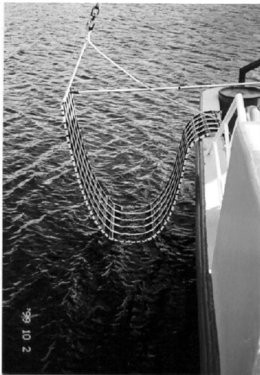
Vue du dispositif de récupération (engin de sauvetage Jason), lorsqu'il est déployé, à bord du NGCC « ÎLE ROUGE » à Tadoussac (Québec)
