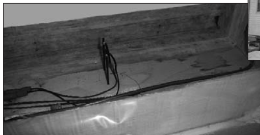
Des taches causées par un dépôt d'eau sur la lisse basse de la cavité murale ont été observées au terme de l'expérience
