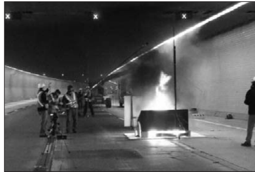
Expériences de détection d'incendie menées dans le tunnel Carré-Viger à Montréal
