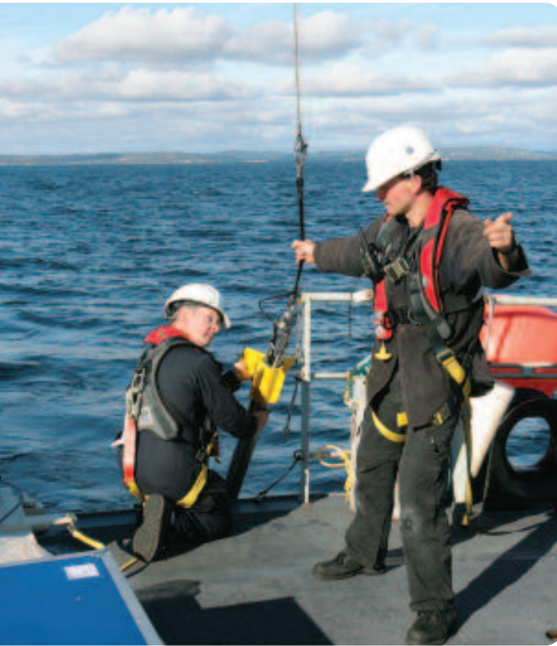
Des employés de RDDC récupèrent la sonde pénétrométrique à cône à chute libre après un essai
