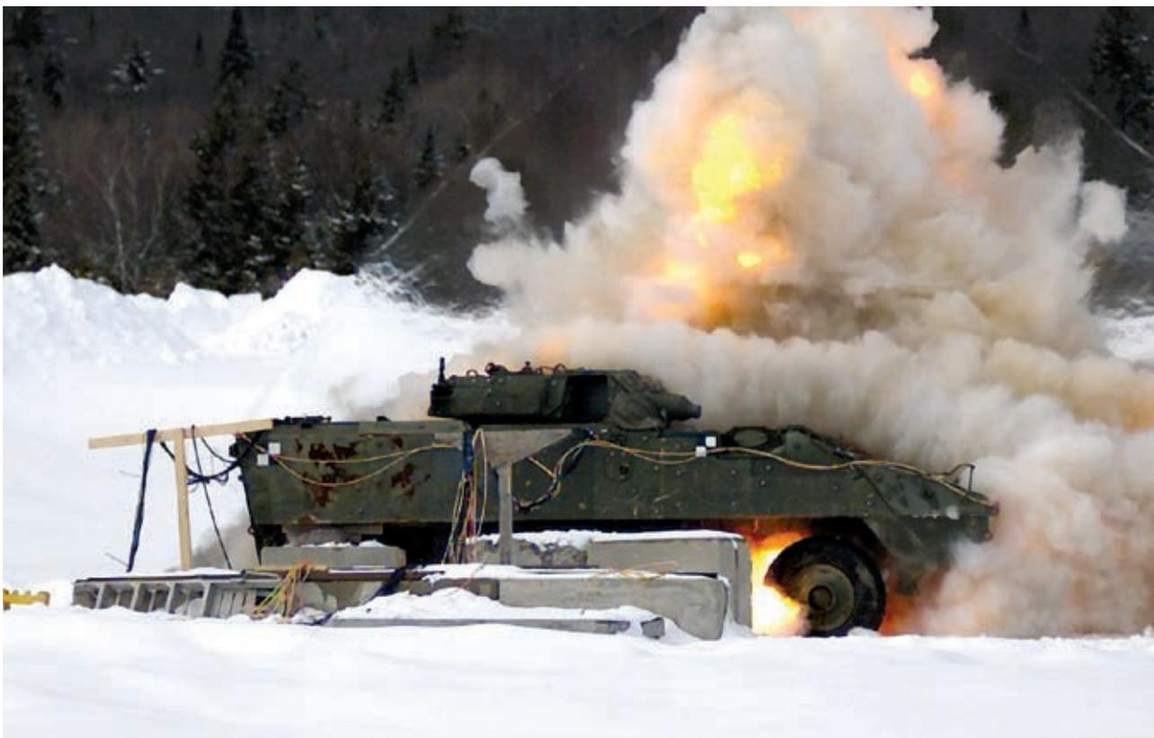
Essai d'un dispositif explosif de circonstance sur un véhicule blindé léger à roues
