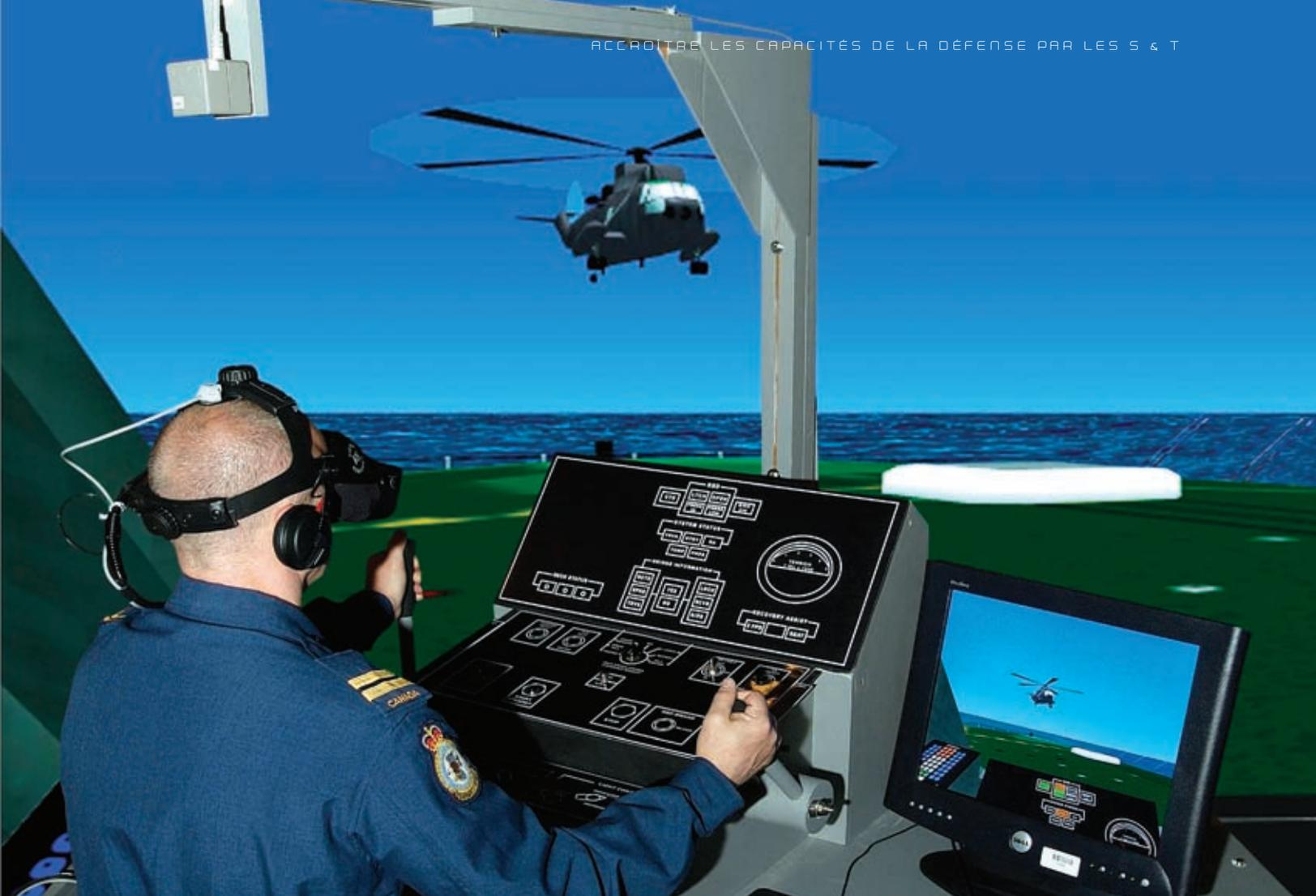
Un officier de signalisation à l'appontage pose un hélicoptère sur un navire en mouvement, dans un environnement virtuel, à l'aide du modèle SimON
