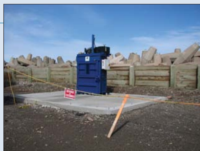
COMPACTEUR À CARTON DE L'ADMINISTRATION PORTUAIRE D'ÉTANG-DU-NORD.
