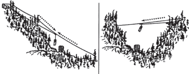
Figure 2.2 - Pont roulant sur câble aérien
