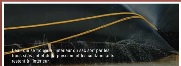
On a traité 80 000 mètres cubes d'eau à l'aide de tubes géotextiles à la mine Tundra cet été, soit un volume supérieur à celui de 30 piscines olympiques!
