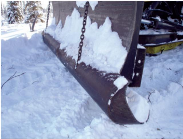
FIGURE 28. Une lame de lissage soulève la lame du boteur de la surface du sol.
