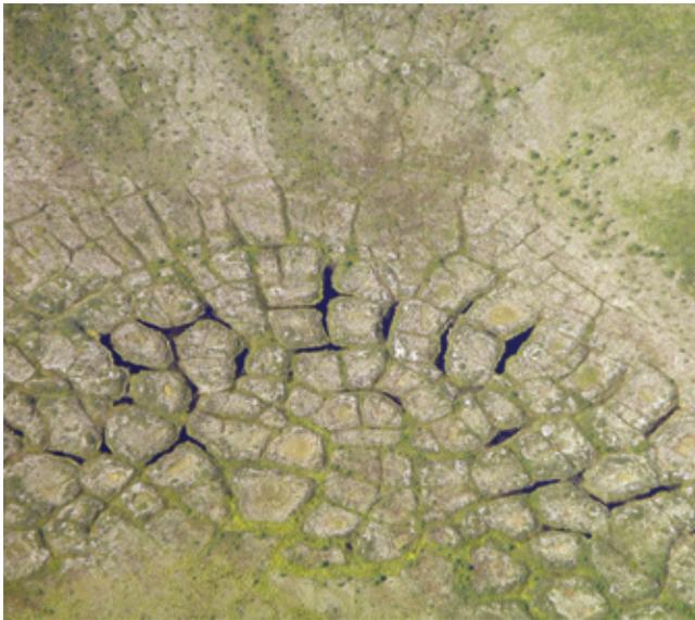
FIGURE 4. Dans le cas d'un terrain de pergélisol, on ne doit pas construire de routes sur un sol géométrique.
