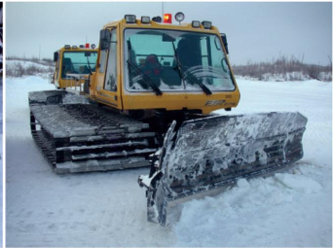
FIGURE 29. Un véhicule à basse pression au sol, comme un tank des neiges, peut être utilisé pour la première passe de compactage de la neige sur une route d'hiver.
