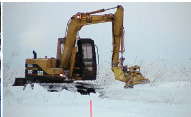
FIGURE 12. Une débroussailluse peut être utilisée pour couper et enlever les broussailles.
