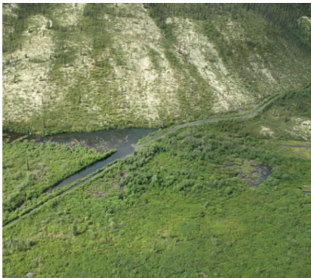
FIGURE 3. Il importe d'effectuer des enquêtes sur le terrain en été et en hiver afin de veiller à ce que la route construite convienne à tout l'éventail des conditions climatiques et hydrologiques du secteur.
