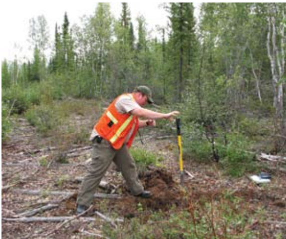
FIGURE 5. Foreuse portative employée pour l'exploration avancée des gisements de matériaux granulaires.
