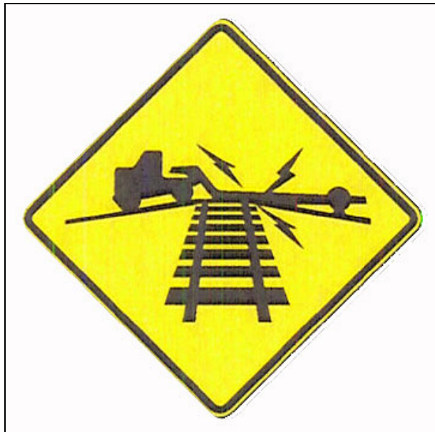
Figure 4. Panneau de signalisation normalisé W10-5 du Department of Transportation des États-Unis indiquant une faible garde au sol
