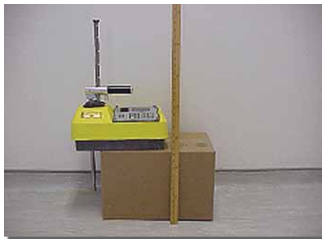
Figure 8. Jauge nucléaire portative de type Troxler dont la source (de type « crayon ») est sortie
