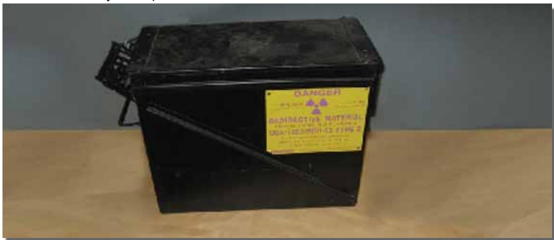
Figure 31. Vue latérale du conteneur illustré à la figure 30; noter que cet emballage en particulier ne nécessite pas d'étiquette de catégorie, mais possède une étiquette d'avertissement jaune qui fait mention du contenu radioactif
