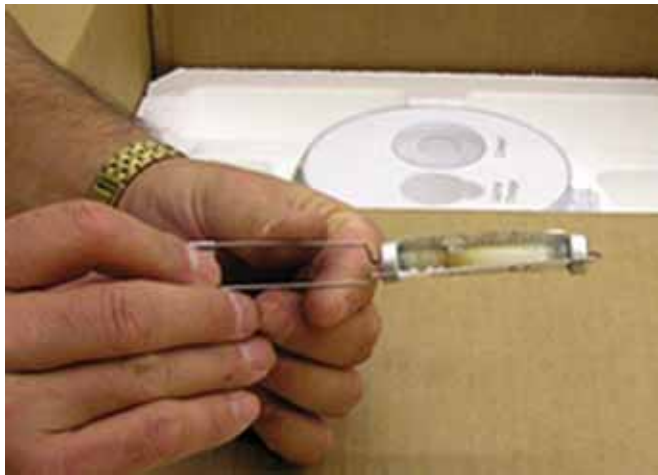
Figure 16. Source de molybdène radioactif (Mo 99) L'emballage est conçu de façon à protéger cette source
