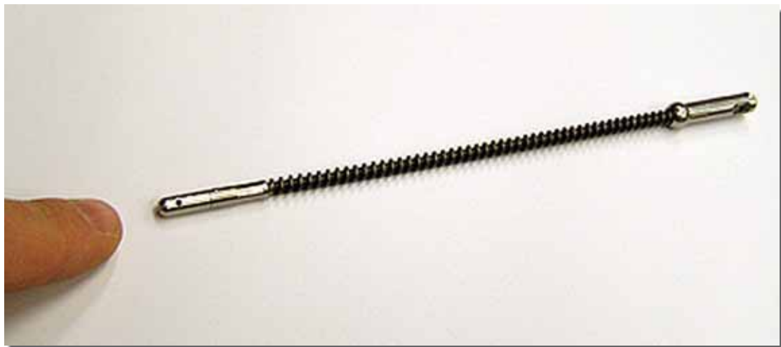
Figure 37. Source étalon contenue dans un appareil d'exposition; la source radioactive se trouve dans le bout de l'appareil, près du doigt, sur la photographie; si vous voyez une telle source, n'y touchez pas et reculez immédiatement de 400 m; reportez vous au tableau 1 de l'annexe pour déterminer le débit de dose gamma
