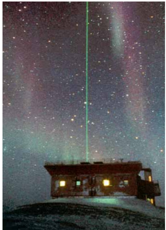
Figure 20. Le Polar Environment Atmospheric Research Laboratory d'Eureka, sur l'île d'Ellesmere, dans l'extrême-Arctique canadien. Le faisceau sortant du toit est celui du laser Lidar.
