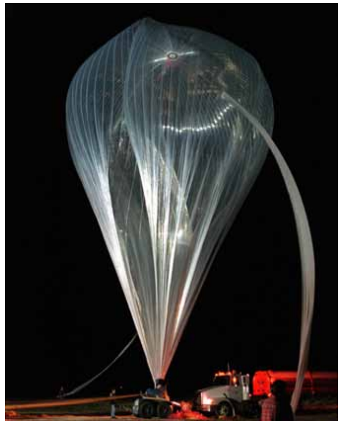
Figure 18. De la hauteur d'un immeuble de 10 étages, le ballon de recherche Mantra transporte jusqu'à une altitude de 35 km des instruments placés dans une nacelle.
