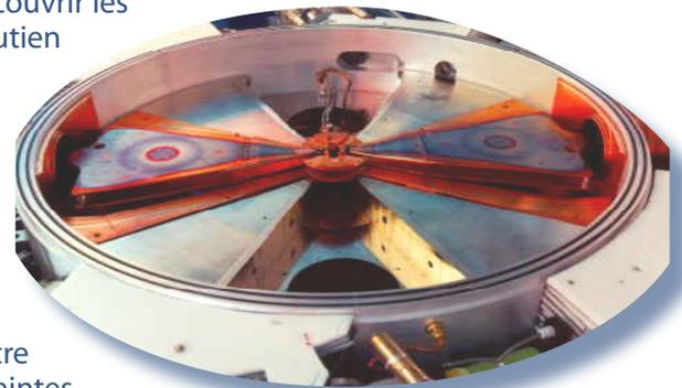
*Vue intérieure des électrodes en D dans un cyclotron producteur d'isotopes médicaux.
