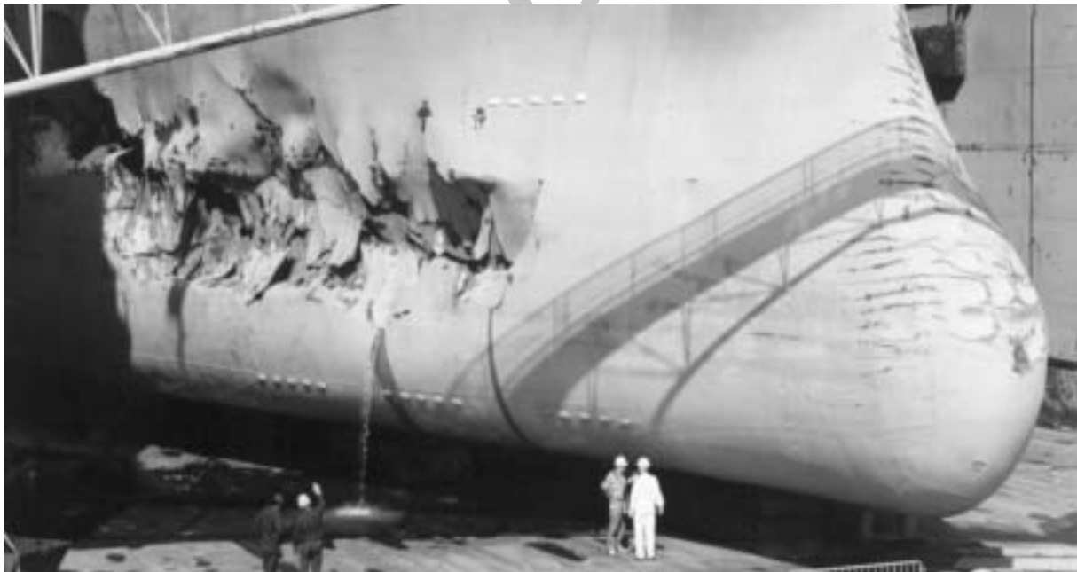
Figure 42 Ce vraquier de type D a été endommagé par les glaces dans le détroit de Hudson
