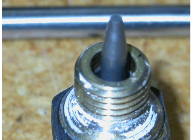
Photo 2. Produit d'étanchéité excédentaire sur un raccord
