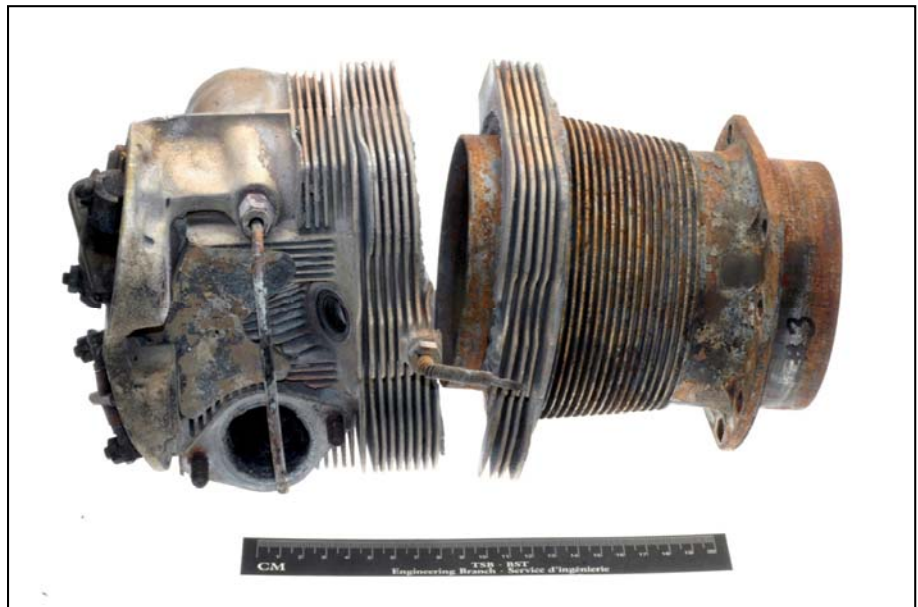
Figure 1. Le cylindre numéro 3 déposé du moteur
