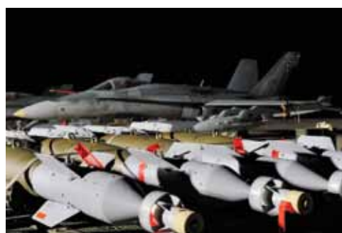
Figure 7. Un CF18 Hornet du 425 e Escadron équipé de bombes à guidage laser pendant l'opération Mobile (Libye). 39
