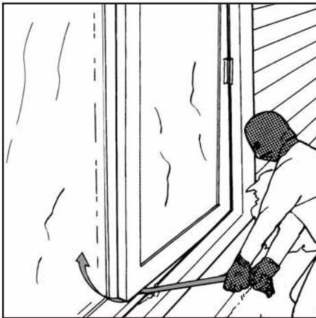
Figure 2 Il est possible de briser le verrou en faisant pivoter le panneau.
