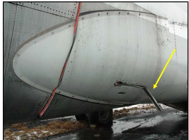
Photo 3. Porte de soute arrière fermée et non verrouillée
