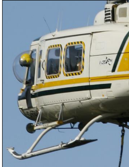
Photo 5. Fenêtre bulle pour le vol par référence verticale (source : magazine Vertical)
