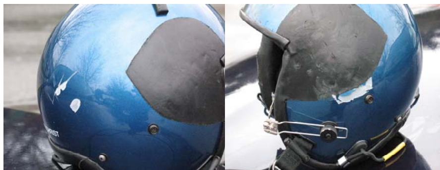
Photo 7. Dommages au casque du pilote
