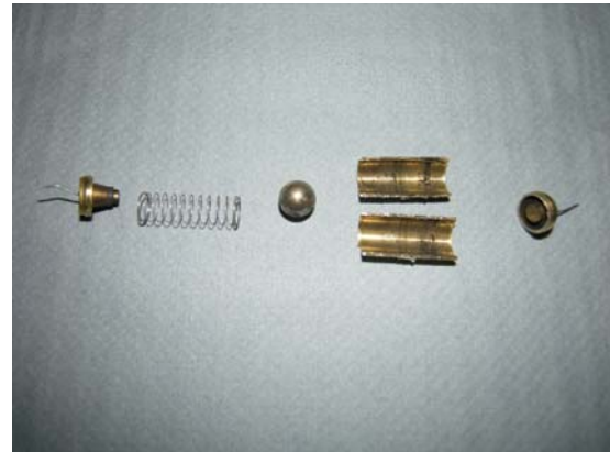
Photo 3. Contacteur à inertie ouvert.
