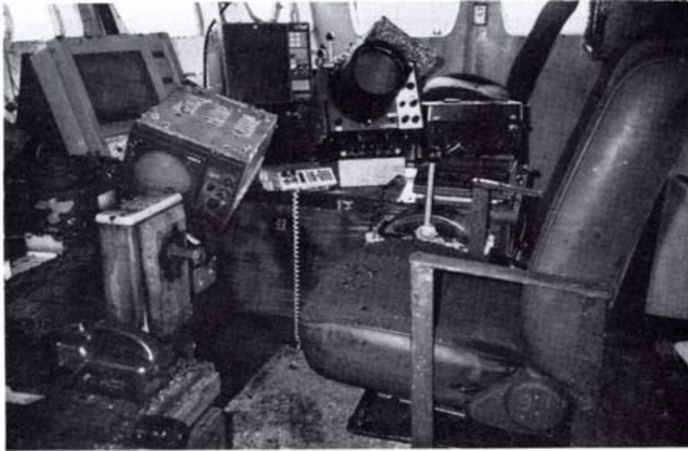
Conning/control station and helm in wheel-house after refloating. Poste de commande et barre dans la timonerie après renflouement.
